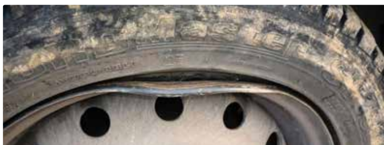
■ Przykład typowego uszkodzenia stalowej felgi po spotkaniu z dziurą w jezdni
